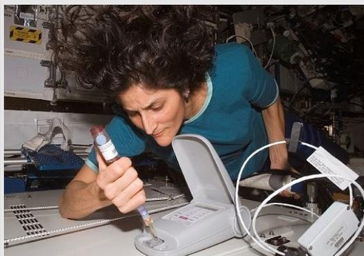
Durante il Marzo del 2007, l'astronauta Sunita Williams ha dimostrato le capacità di LOCAD rilevando batteri di tipo Gram negativi nel Nodo-1 e nel modulo US-Lab.
